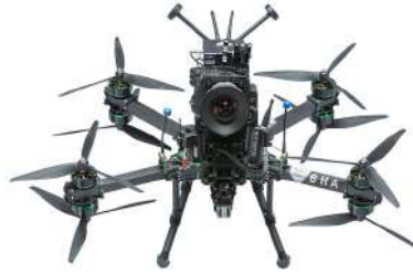
Gambar 3. COBRA Drone FPV dengan Gimbal mounting Sumber : www.beverlyhillsaerials.com
