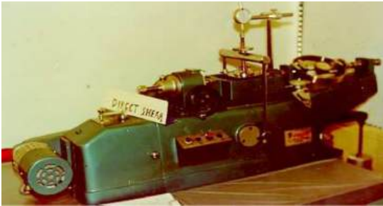
Gambar 5. 11 Alat Uji Geser Langsung (SNI 2813:2008)
