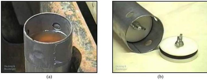
Gambar 3. 7 Metode Penyegelan Tabung Shelby
