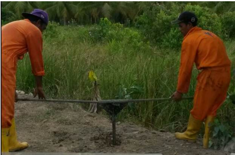
Gambar 3. 14 Pengambilan contoh tanah dengan bor tangan.
