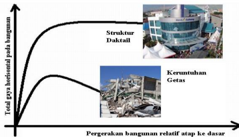
Gambar 3.2 Perilaku struktur daktail dan getas (sumber: https://hesa.co.id/konsep-daktilitas-pada-struktur-bangunan )
